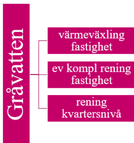
Figur 4-12. En lågenergikrävande lösning för grävattnet i stadsdel Loudden.
